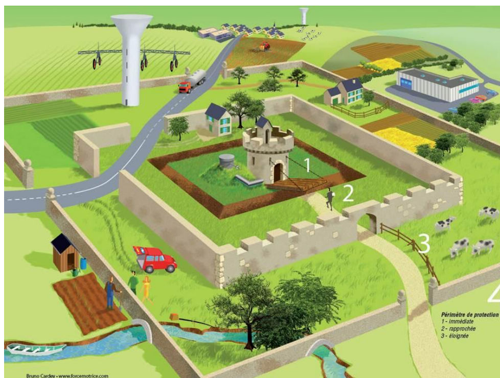
REPRÉSENTATION DES PÉRIMÈTRES DE PROTECTION D'UN CAPTAGE
